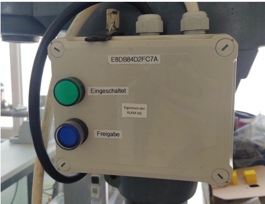
Noch ein Shelly im Gehäuse - schaltet 400V und hat einen extra Freigabe-Schalter
