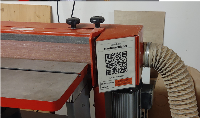
Die Lüfterklappensteuerung an einem Bandschleifer
