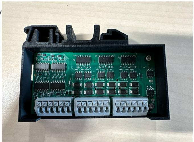
Unsere Steuerplatine, welche per USB an einem Raspi hängen (ein oder mehrere). Steuern Türen und Schütze mit 12-24V an. Mehr Details gibt's bei [@chca42](#) der sie Entworfen und fertigen lassen hat.
